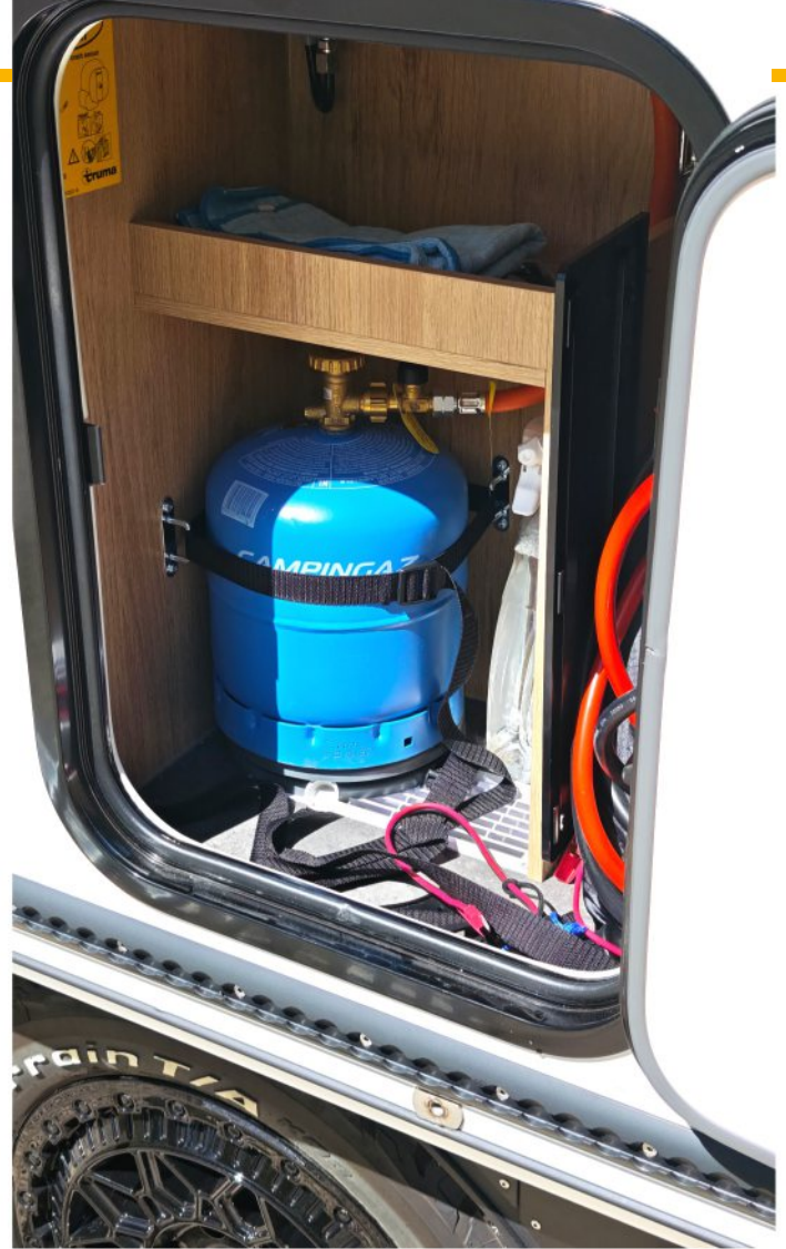
In das Gasfach passt eine 2,75-kg-Campingaz-Flasche. Das reicht zum Kochen. Für Heizung und Warmwasser ist in der Tischer Box 260 SP neuerdings eine Truma Kombi-Dieselheizung verantwortlich.
